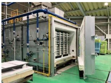
台車に製品を積み上げし、炉内へ収納、予熱・焼成・冷却してから製品を取り出す。一回の焼成ごとに22時間かかるため生産効率は落ちるが、その分燃料効率が高い。LPガスとプロパンガスの混合ガスを使用し、焼成を1,300℃の高温で行う。温度と燃料の調整は電子制御され、最適かつ効率的に焼成ができる。また、排煙も従来のトンネルキルンと比較し、NO<sub>x</sub>などの排出を極力抑制するシステムとなっている。
