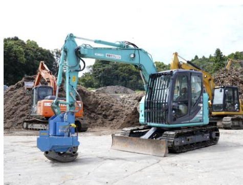
0.25 バックホー（グラブ装置付）6 台
